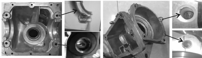
(a) 抽芯针旁缩孔 (b) 右、上抽芯孔底气孔 图 10 左侧抽芯针旁边缩孔及右、上抽芯孔底气孔
